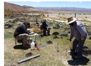
*Abb. 12: Geoelektrische Baugrunduntersuchung im November 2020 (EcoAndina, 2020).*
